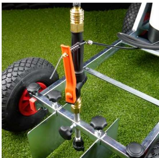
Das Schnellschlussventil vorn auf die Ventil-Steckdose stecken.
