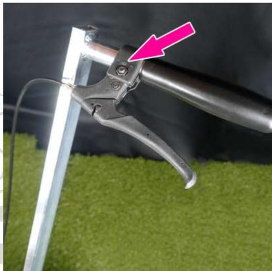
Den Gummigriff vom Holm ziehen und den Bedienhebel auf den Holm aufstecken. Diesen nun mittels der Schraube festziehen und den Gummigriff wieder auf den Holm stecken.
